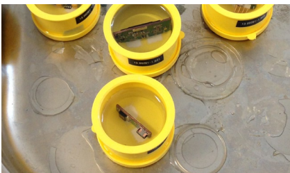
Wie viel Mal Drücken halten die Tasten der Gigaset-Telefone aus? Der Belastungstest zeigt's (oben). Zudem werden in Harz gegossene Bauteile per Mikroskop untersucht – so fallen auch kleinste Sollbruchstellen auf.
